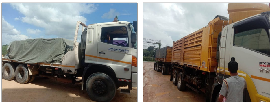
รูปที่ 3.2-5 ผ้าใบคลุมวัสดุอุปกรณ์ก่อสร้างอย่างมิดชิดระหว่างการขนส่งวัสดุอุปกรณ์ก่อสร้าง
